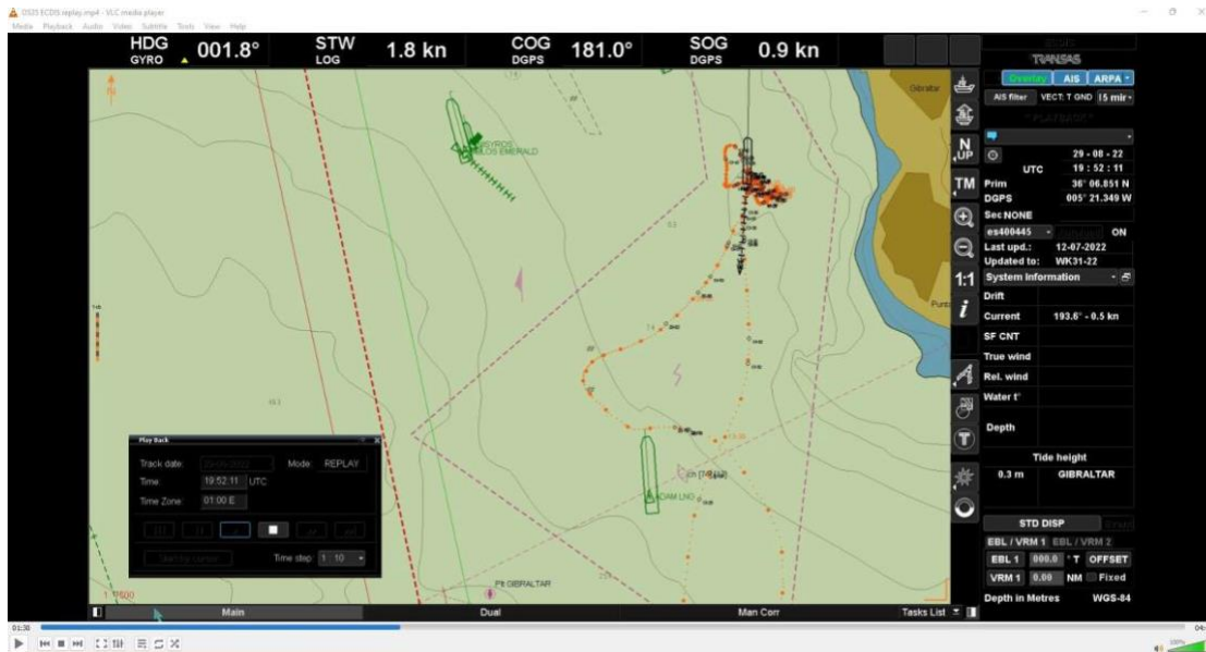
Figura 20: Pantalla del ECDIS del “OS 35” mostrando el vector con SOG y COG
